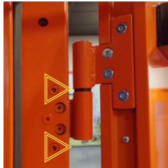
Vis pour réglage du jeu de feuillure en largeur (dans les triangles)
